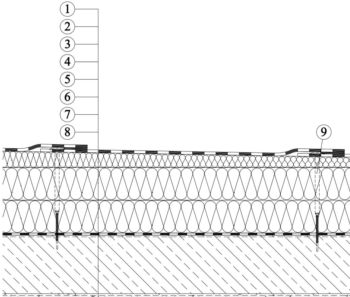
1. Povlaková hydroizolace (PIB, mPVC, TPO, FPO aj.)
